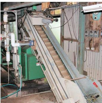
図9 蒸し機1 コンベアで生葉が蒸し機に送り込まれる
